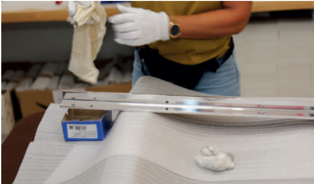
Vor der Montage werden die polierten Seitenstreben noch einmal gereinigt
