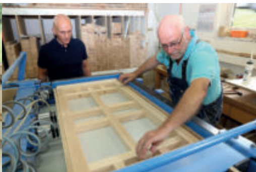
In dieser Presse bleibt der Rahmen, bis der Leim abgebunden hat
