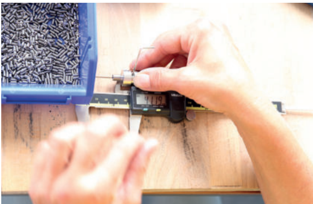
Die Länge des schwingenden Stabes wird eingestellt
