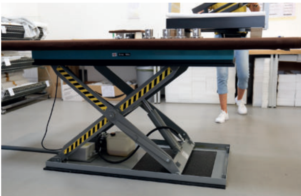
Auf diesem motorisch höhenverstellbaren Tisch werden die Racks in Handarbeit montiert
