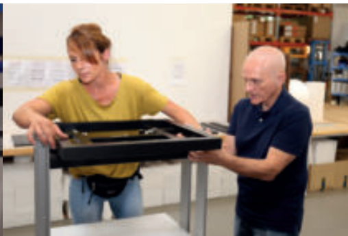
Der Rahmen für die obere Ebene wird eingesetzt
