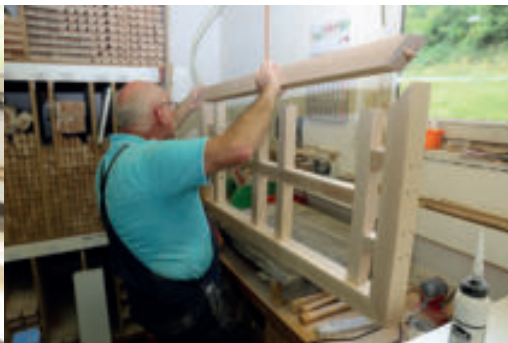
Hier montiert er einen Rahmen für ein 123 Zentimeter breites Rack
