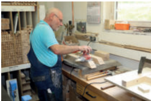
Vor der Weiterverarbeitung schleift Georg Klose die Halbfertigteile noch einmal
