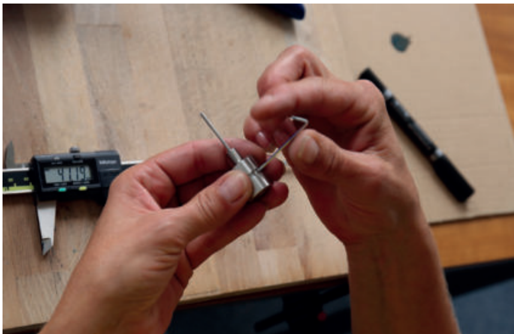
Der Resonator-Stab wird in seiner Aufnahme fixiert
