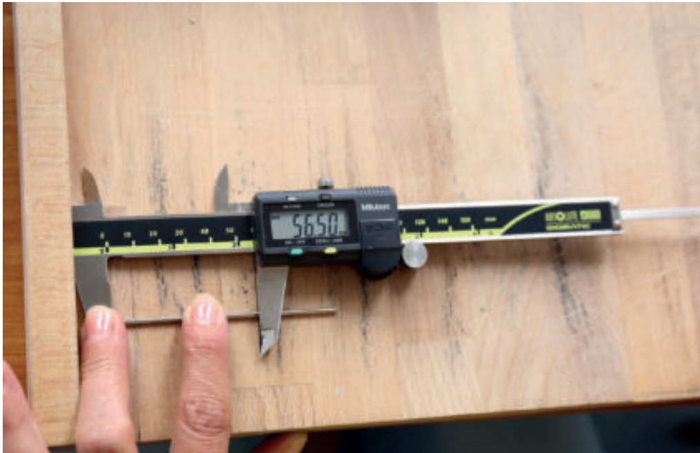
Die Gesamtlänge eines Resonators wird bestimmt
